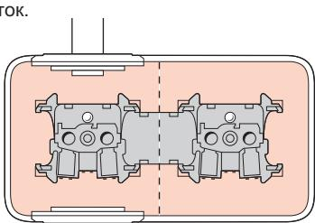
Крепление верхней части к монтажной коробке, обеспечивающее степень защиты выключателя IP55, выполняется поворотом отвертки на 1/4 оборота. Направление поворота отвертки указано на крышке.
