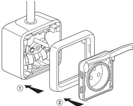
Крепление верхней части к монтажной коробке, обеспечивающее степень защиты выключателя IP55, выполняется поворотом отвертки на 1/4 оборота.
