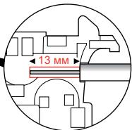
Требуемая длина защищенного кабеля - 13 мм. Используйте шаблон, расположенный на задней панели механизма, для определения точной длины. Емкость клемм : от 1,5 мм<sup>2</sup> до 2,5 мм<sup>2</sup> (1 или 2 проводника).
